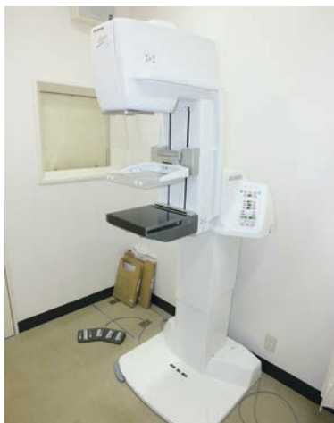
マンモグラフィーは乳腺・乳房専用のX線（レントゲン）撮影装置です
